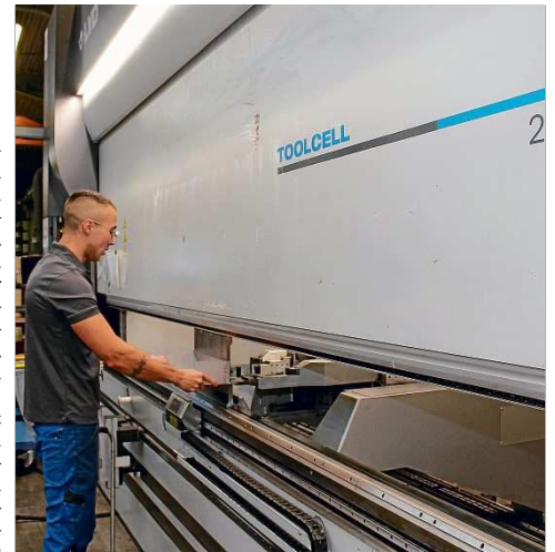
Abkantung nach Zeichnung: Nach dem Lasern werden die Teile entsprechend den kundenindividuellen Vorgaben abkantet.
