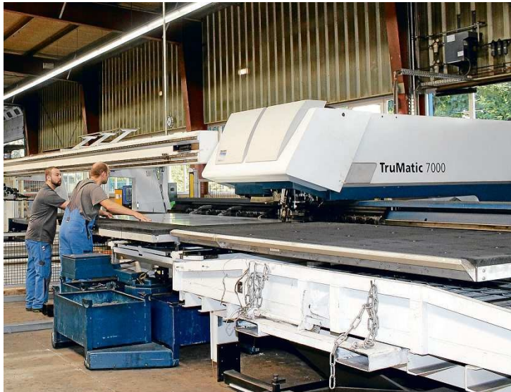
Perfektion auf Maß: Die vollautomatische Stanz-Laser-Bearbeitung ist hocheffizient.
